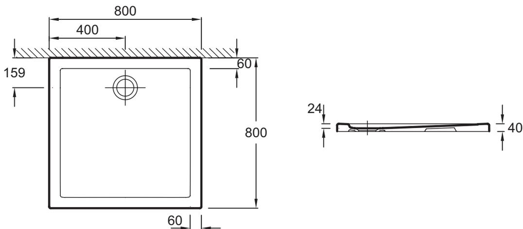
Descriptif CCTP : Receveur extra plat à poser ou à encastrer 80x80 cm. ENB90. Collection : KYREO. DIMENSIONS : 80 x 80 x 4 cm. POIDS : 24,3 kg. MATÉRIAU : Céramique. TYPE D'INSTALLATION : Posé ou encastré. NORMES ET RÉGLEMENTATIONS : NF. FORME : Carré. DIAMÈTRE DE BONDE : 90 mm. MOTIF DE SURFACE : Lisse. NIVEAU D'ADHÉRENCE : PN6. LIVRÉ AVEC BONDE : Niet.
