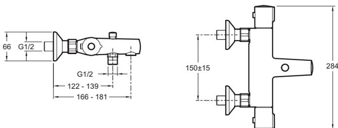
Description : Mitigeur thermostatique bain-douche mural. E45714. Collection : JULY. Poids : 2,1 kg. Installation : Mural. Normes : NF : ID/A - ECAU : E3/1 C3 A2 U3 - Ge5. Débit : 20 l/mn sous 3 bars. Raccords : Avec raccords muraux. Mécanisme : Cartouche thermostatique à cire dilatable. Entraxe : 150 mm +-15. Economie d'eau : butée escamotable à mi-débit. Clapet anti-retour sur alimentations.
